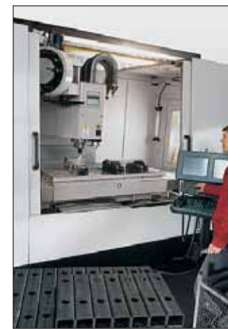
Ein modernes Dreiachsensbearbeitungszentrum.
