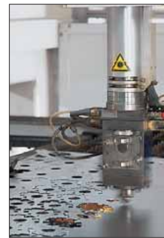
Schneidkopf eines Flachbettlasers mit Rohrlasereinheit.
