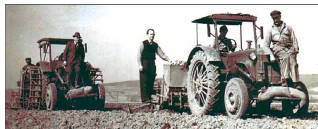
Eine Werbeaufnahme aus 1950 zeigt die erste vollautomatische Kartoffel-Legemaschine.
