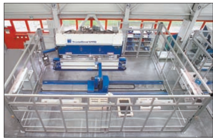
Ein neuer Abkantroboter der Firma Trumpf wird ab Mai den Maschinenpark bei Heinzig bereichern.
