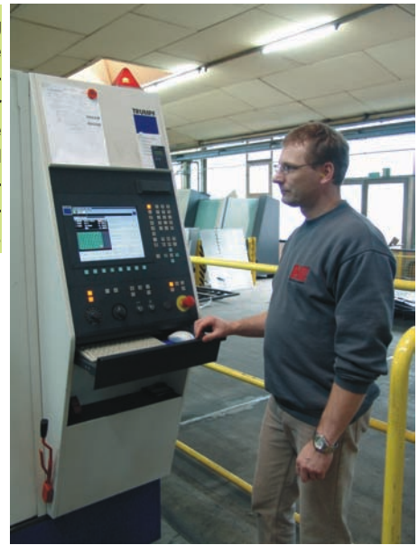
In der Blechbearbeitung ist das Laserstanzen die dominierende Bearbeitungstechnik. Neben der Laser-Stanzmaschine TruMatic 600 soll alsbald die TruMatic 6000 für zusätzliche Fertigungskapazitäten verfügbar sein.
